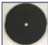
Le décor effet alu noir après 100 cycles d'abrasion : trace d'usure à peine perceptible.
