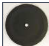
Un coloris plaxé standard noir après 100 cycles d'abrasion : une décoloration clairement visible avec un changement de brillance.
